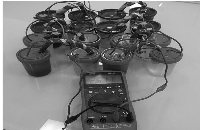
Рис. 5. Блок топливных элементов
